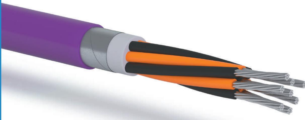
**Кабели термоэлектродные с жилами из сплавов или из сплавов и металлов с изоляцией и оболочкой без экрана, с броней из стальных оцинкованных лент**
