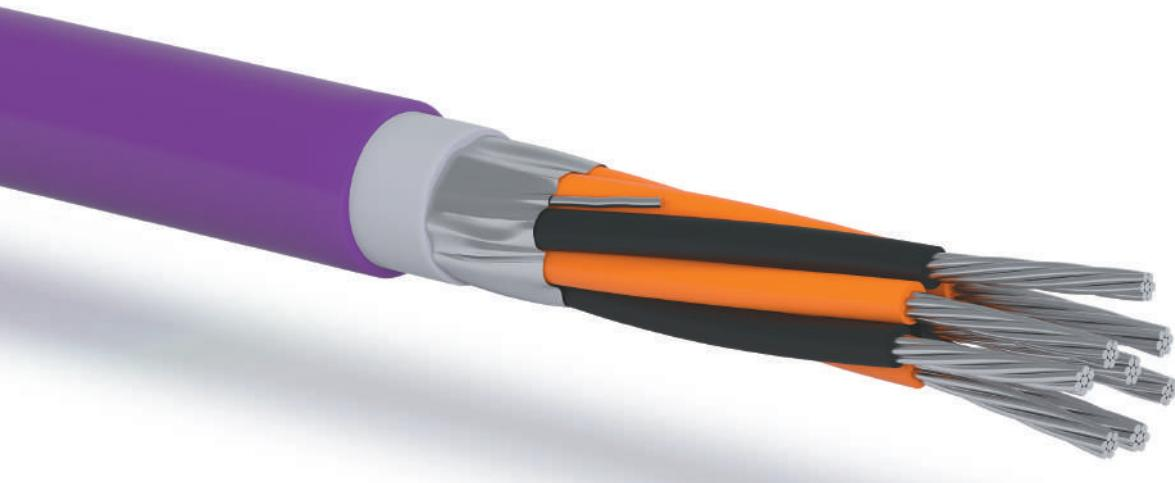
**Кабели термоэлектродные с жилами из сплавов или из сплавов и металлов с изоляцией и оболочкой экранированные, с заполнителем**
