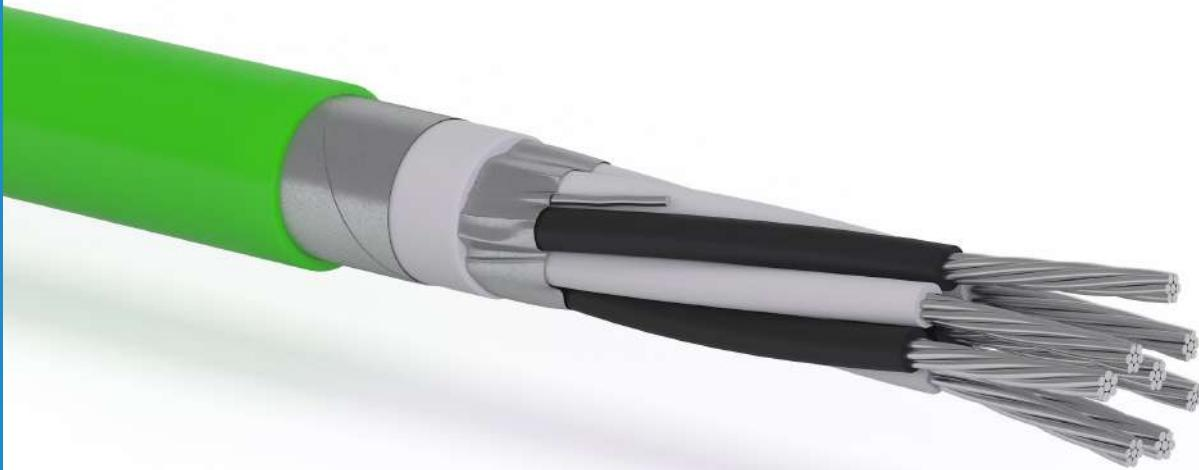
**Кабели термоэлектродные с жилами из сплавов или из сплавов и металлов с изоляцией и оболочкой экранированные, с броней из стальных оцинкованных лент**
